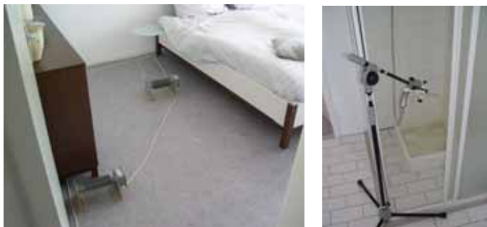
Figuur 4-2: Simulatie van bewonersgedrag in de testwoningen op het terrein van het ECN. Links: slaapkamer met verwarmingselementen die de afgifte van warmte door mensen en huishoudelijke apparaten voorstellen. Rechts: standaard waarmee een douchekop wordt vastgehouden. Foto's overgenomen van [12, Appendix A].
